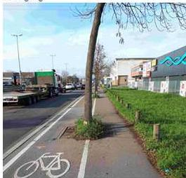
**Gefahrstelle PRIO 1 Rheinallee 96: zu enger Zweirichtungsradweg (KE/KU) (lfd. Nr. 4)**
