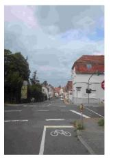
In stadtauswärtiger Fahrtrichtung ist zwar ein Taster für Radfahrende angebracht, aber die Haltelinie für Fahrzeuge befindet sich rechts vor der Ampel, so dass die Durchfahrt durch Fahrzeuge bei Rotlicht versperrt sein kann.
